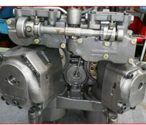
La transmission à variation continue VARIO hydraulique a été inventée par la marque de tracteur FENDT dans les années 80, cette transmission hydro-mécanique innovante a été commercialisée en 1996, par Fendt.
